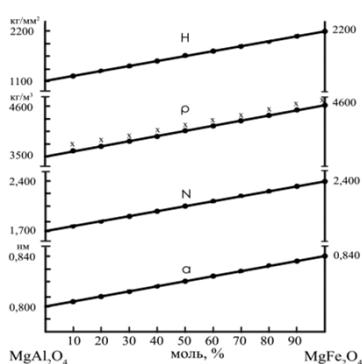
Rasm.  $MgAl_{2(1-x)}Fe_{2x}O_4$  qattiq eritmasi parametrlarini o'zgarishi:
