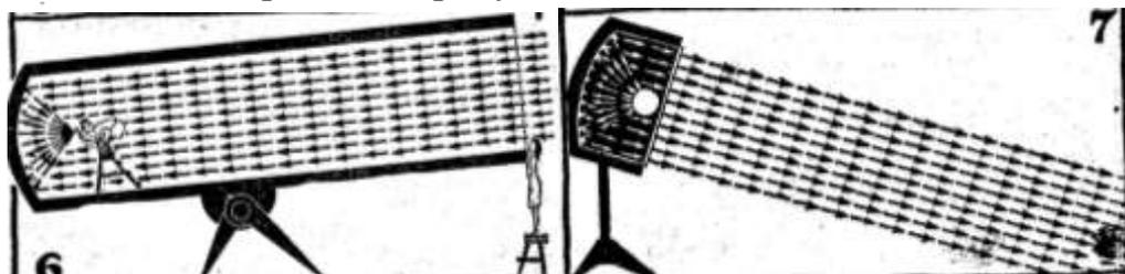
7) У прожекторов зеркало обычно делается в форме параболоида. Если поместить источник света в фокусе параболоида, то лучи, отразившись от параболического зеркала, образуют параллельный пучок.
