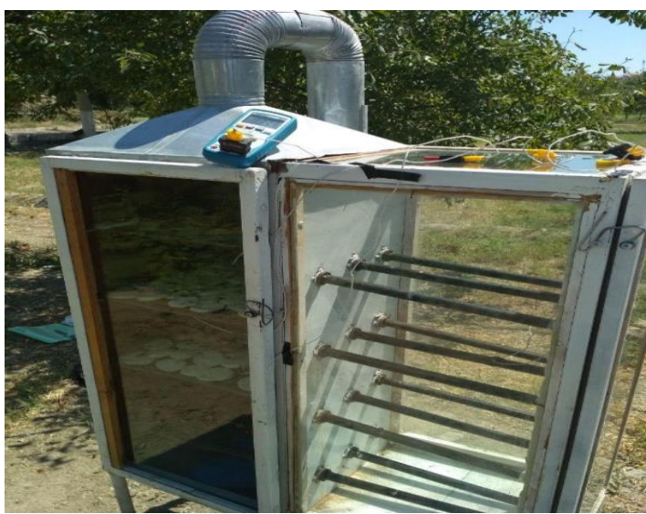
1-rasm. Issiqlik quvuri yordamida ishlaydigan quritish uskunasi sxemasi va modeli
