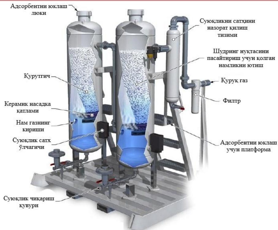
1– расм. Қаттиқ ютувчилар ёрдамида газларни адсорбцион қуритишнинг технологик схемаси
