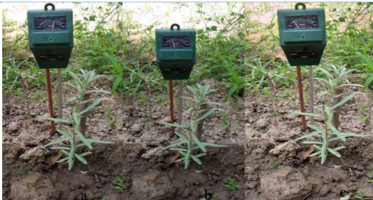
3.1-rasm. Tuproq namligi, yorug'ligi va pH ko'rsatkichlarini aniqlash, (a-namlik, b-yorug'lik ko'rsatkichi, c-pH ko'rsatkichi)
