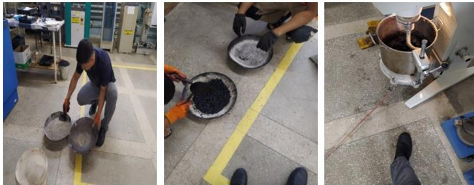
2-рasm. Asfaltbeton qorishmasini aralashtirish jarayoni.
