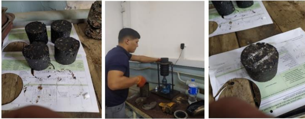
3-rasm. Asfaltbeton qorishmasidan namunalar tayyorlash jarayoni
