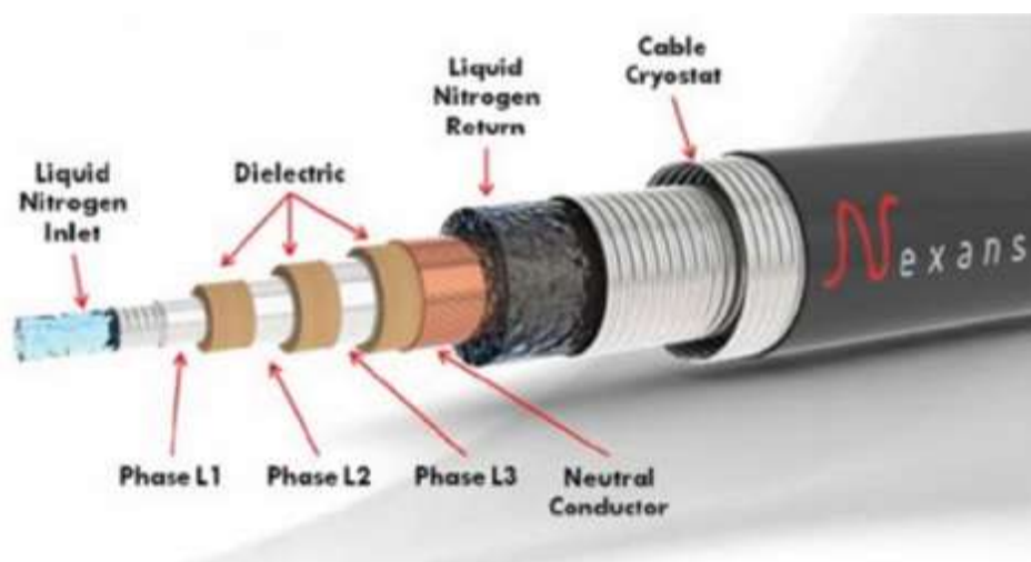
5-rasm. Nexans tomonidan ishlab chiqilgan HTS elektr uzatish kabeli
