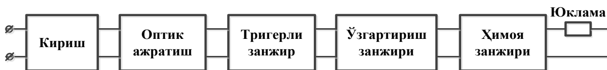
2-расм. Қаттиқ қатламли реленинг тузилиши схемаси
