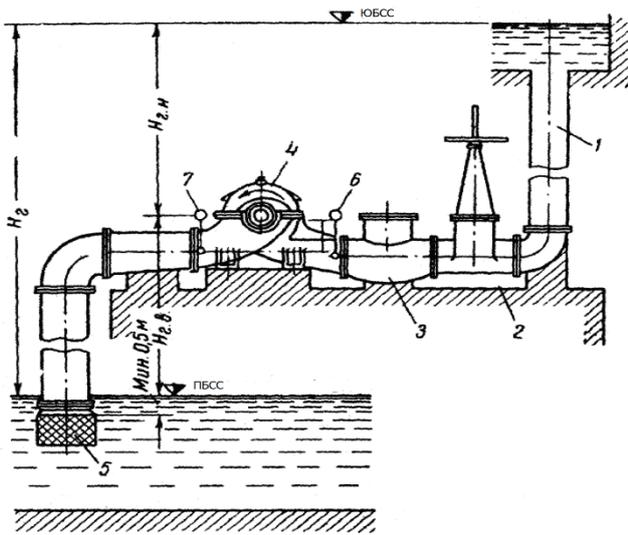
1-расм. Насос қисмларини абразив емирилиши ўрганувчи экспериментал қурилманинг схемаси:
