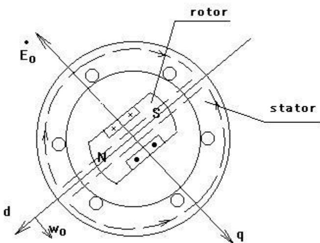
Sinxron motoring qismlari rotor, stator
