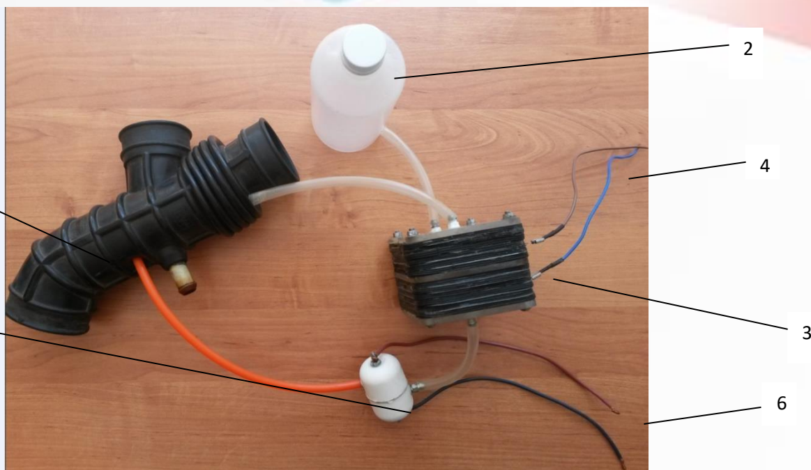
Рис. Реактор для автомобиля "Нексия-3": 1- воздушный патрубок; 2- бак для воды; 3- электролизер; 4- провода штекерного соединения 12 В; 5- озонатор; 6- провода высокого напряжения 6-30 кВ.
